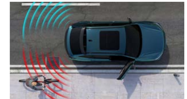
Door Open Warning
